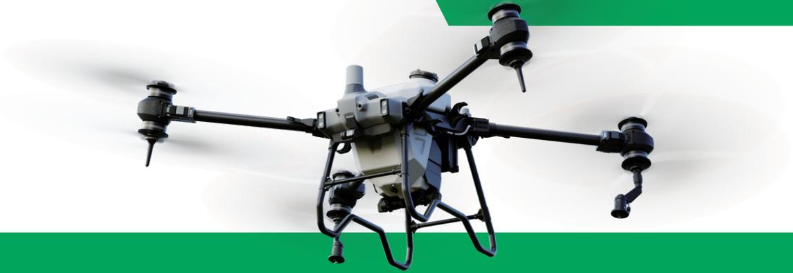
El AGRAS T40 está equipado con el revolucionario diseño de rotor doble coaxial, que le permite transportar una carga de rociado de 40 kg y una carga de esparcido de 50 kg (70 l). La aeronave viene con un sistema de rociado atomizado doble integrado, DJI Terra, radar de matriz en fase activa y visión binocular. Es compatible con múltiples misiones, como la topografía, la cartografía, el rociado y el esparcido, lo que le ayuda a lograr la máxima precisión en sus operaciones agrícolas.
